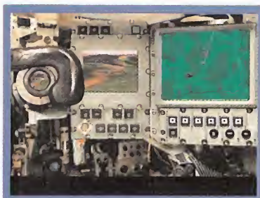
Desde la pantalla del artillero se podrá elegir objetivo, cargar el cañón y dispararlo en la dirección deseada.
